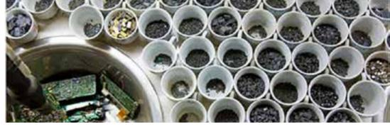
Separación de los materiales de las placas de circuitos.
