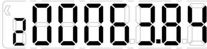
Figura 14 – Indicación de la Energía Activa Reversa en la pantalla
