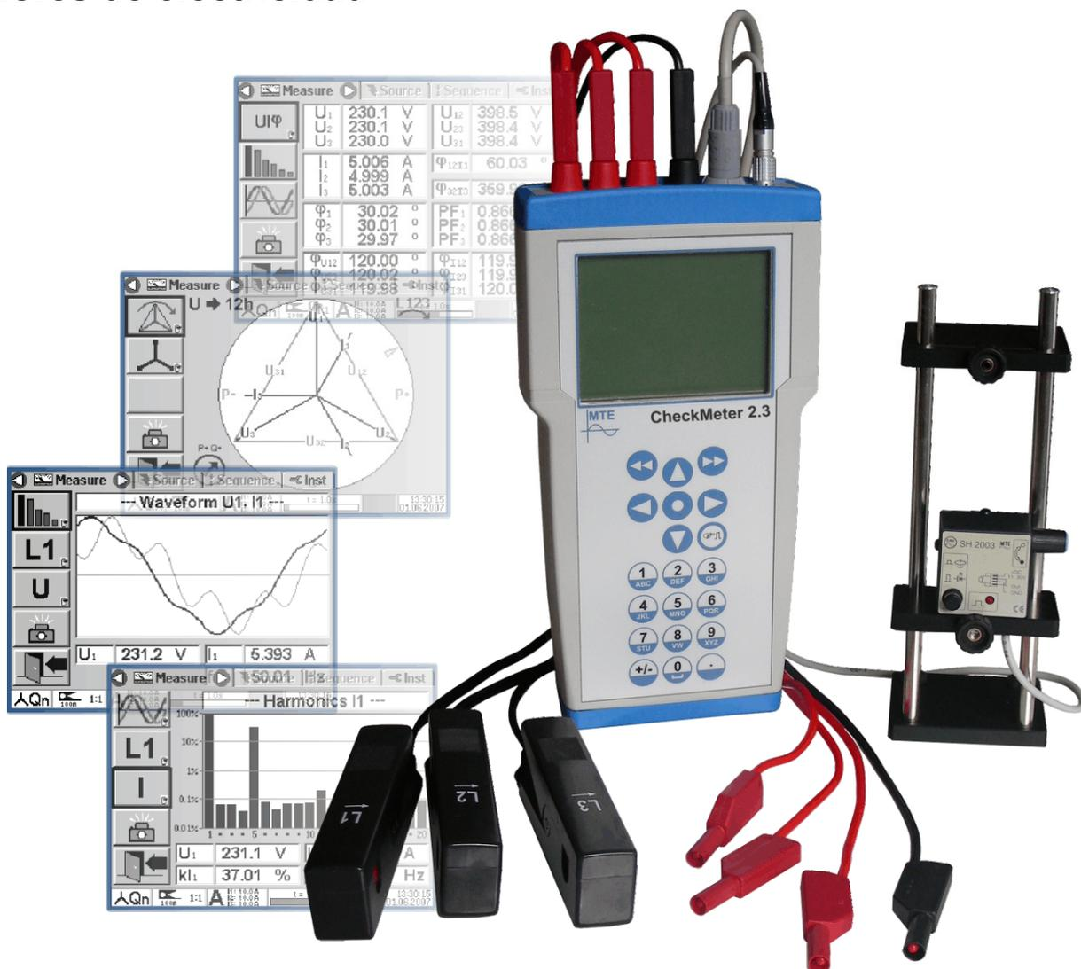
El instrumento CheckMeter 2.3 de clase 0.2% es un patrón de verificación electrónico trifásico portátil, para el ensayo tanto de contadores de electricidad monofásicos así como trifásicos "in situ".
